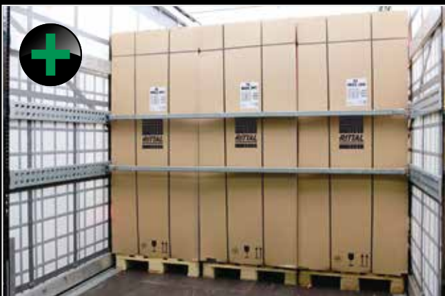
Barre fermacarico utilizzate come dispositivi di fissaggio del carico sul retro della cassa.
