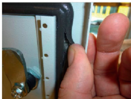
Afbeelding 6: ingesneden afdichting na de IK-test
